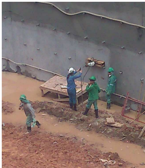
Figura 17.36 - Posicionamento do deflectômetro para o ensaio de G.7. (18/09/14)
