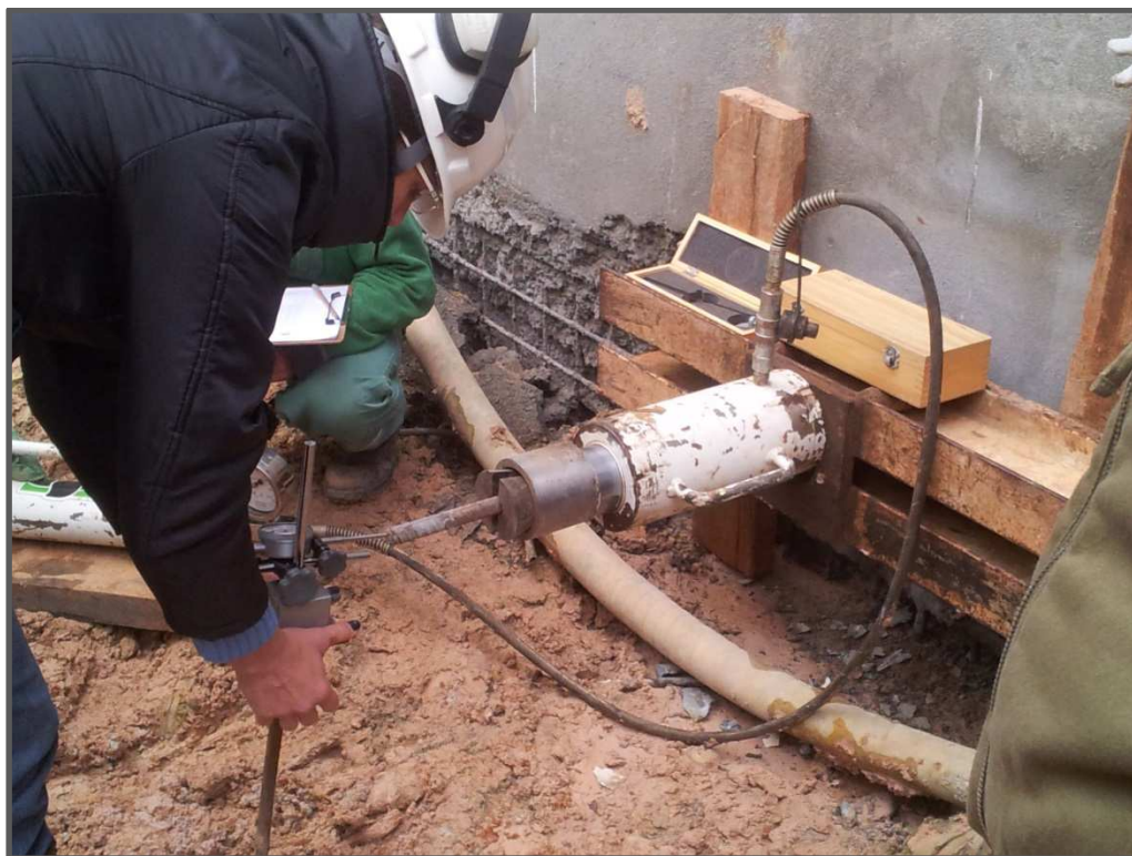
Figura 17.26 - Posicionamento do deflectômetro para o ensaio de G.4. (15/08/14)
