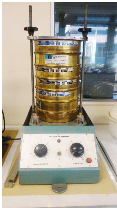
Figura 18.1.4 - Amostra em agitador antes do peneiramento fino
