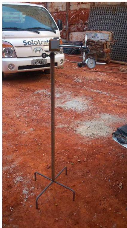
Figura 17.12 - Apoio com base magnética e deflectômetro. (02/07/14)
